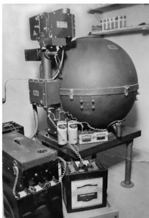
Medidor de rayos cósmicos, modelo C, instalado en Teoloyucan, Estado de México. 26 de julio, 1938. Foto: CIS Archives.<sup>34</sup>
